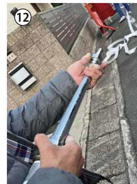
⑫ 筒先を火災の方向に向けて構える。
